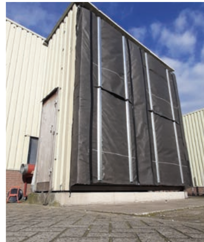
Testkast met beproefde CLADIWALL gevelsysteem
